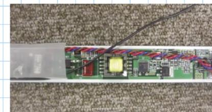
昨年11月、北人工駐車場を中心に蛍光灯を省エネ型のCCFL(冷陰極蛍光管)に交換した事は、既にリベ・コミで、ご紹介しました。順調に省エネ効果＝電気料金の節約に繋がっていますが、寿命4万時間の触れ込みながら、4本のCCFLが、切れる事故が続いていました。原因を調べていたCCFLの製造メーカー、北九州市小倉北区上到津の株豊光社は、CCFL内部の電源回路のコイル状トランス(生産委託先・台湾)に不具合があったことを突き止めました。昨年11月、リベラに納品したCCFLだけに、不具合が集中したそうです。そこで、8月2日、メーカー負担で40W型のCCFL356本を全交換しました。この日は、最高気温37.5度の猛暑日、6人の若手社員が背の高い脚立に乗って、夜までには、すべて交換を終えました。不良品の交換という出会いでしたが、カットモデルについても、丁寧に、ご説明頂き、メーカーの誠実さを感じる1日でした。尚、CCFLは、メーカーと販売店を含めて2年保証付きです。(U)
